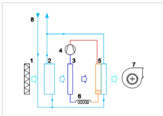
Figura 2 - Schema di funzionamento con aria neutra
